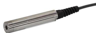
El sensor de oxígeno disuelto óptico **E-LUMIN** proporciona mediciones fiables de oxígeno disuelto durante una larga vida útil. No hay membranas para reemplazar, no hay soluciones de electrolitos para reponer, y no hay ánodos para limpiar. Mantener el sensor es tan fácil como reemplazar la tapa de detección óptica una vez cada 1-2 años, y dado que todos los datos de calibración se almacenan en la tapa, no es necesario calibrar.
